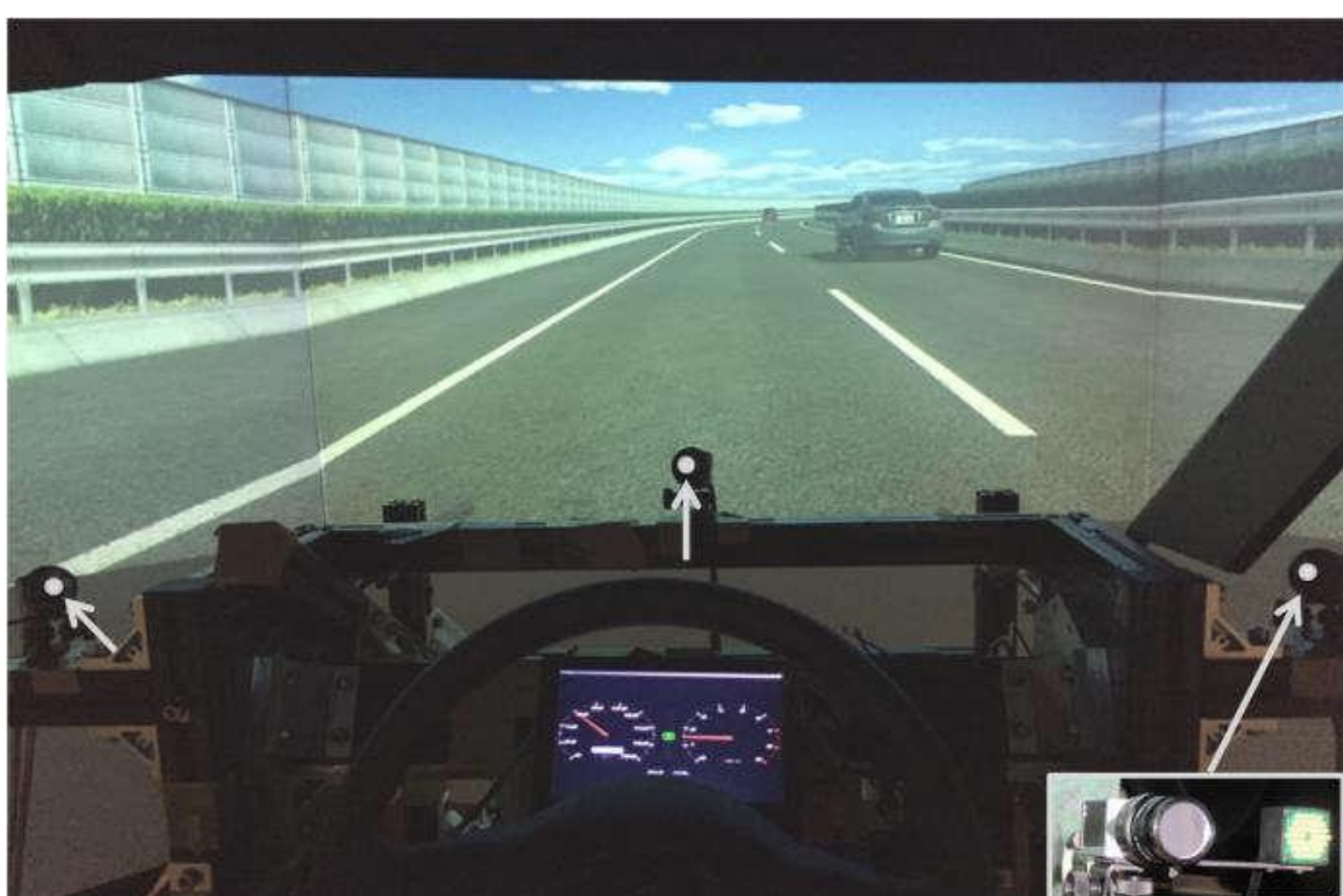
ドライビングシミュレーターとSmart Eye Pro アイトラッキングシステム
